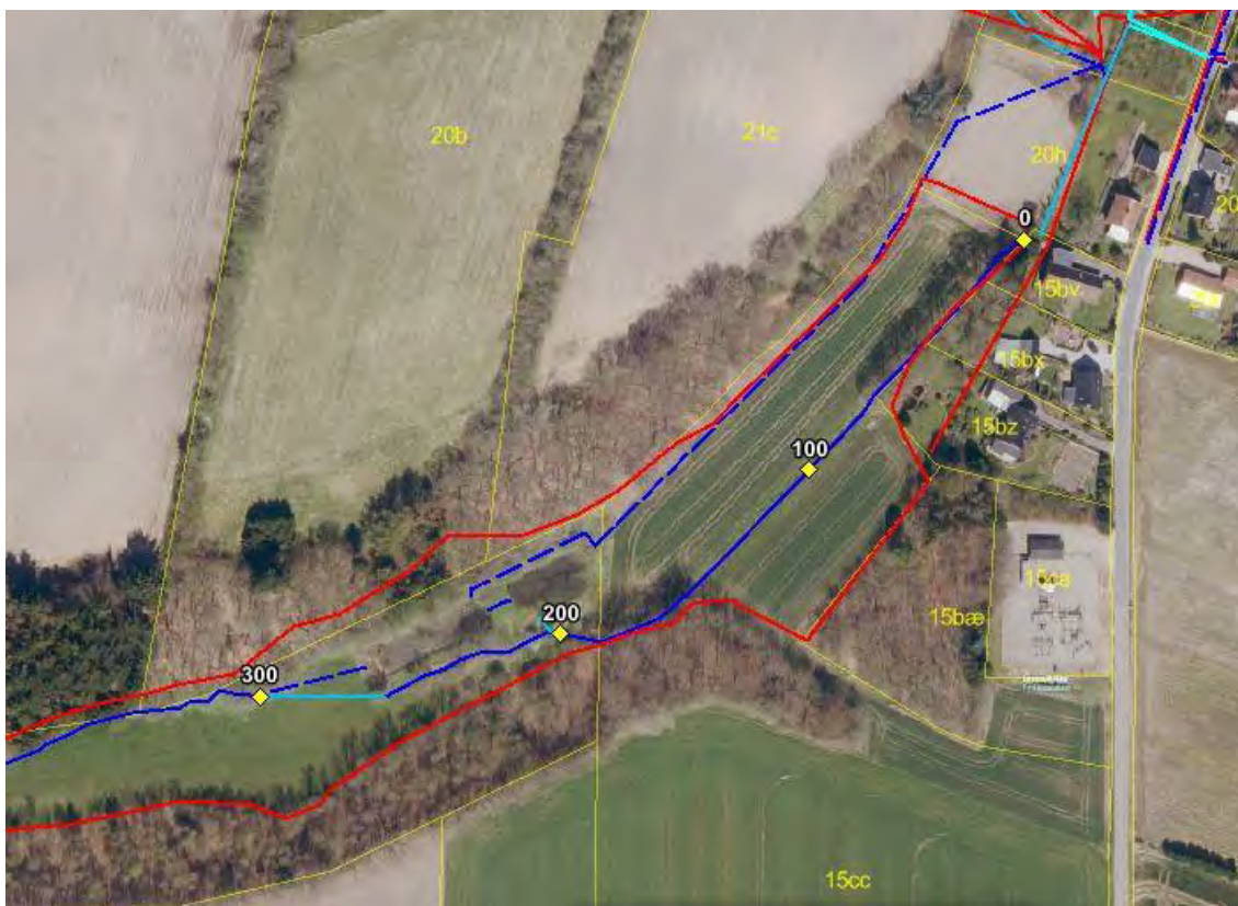
Figur 7 Regnvandsledning fra Silkeborg Forsyning med afvanding til Kringelbæk inden for undersøgelsesområdet
