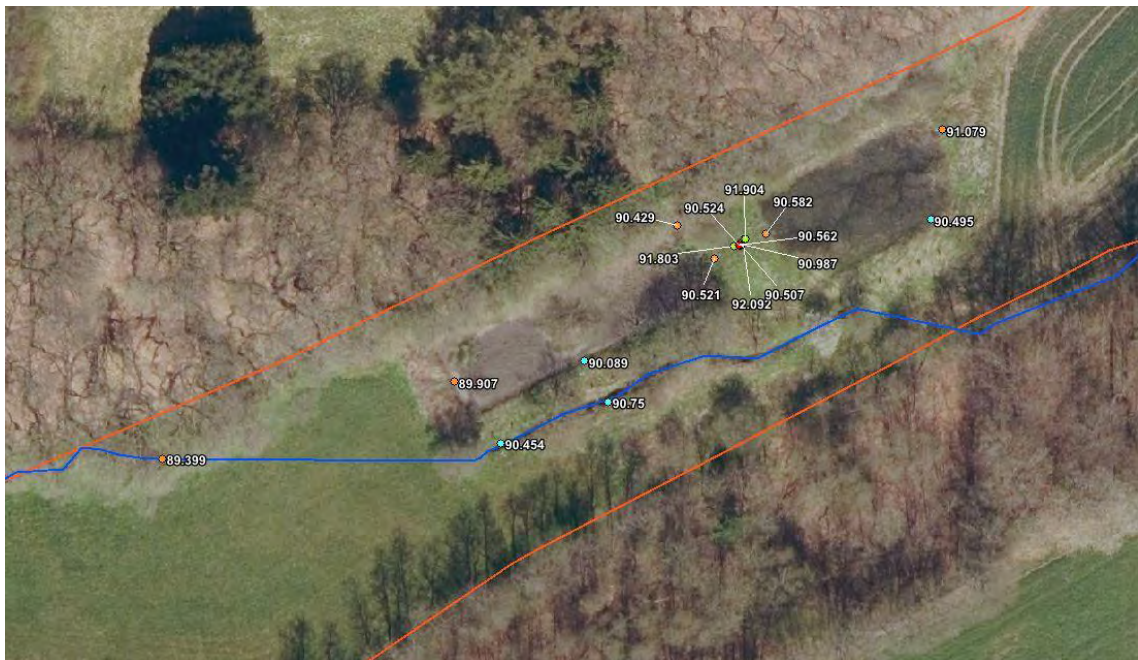
Figur 6 Regnvandsbassin med udløb til Kringelbæk
